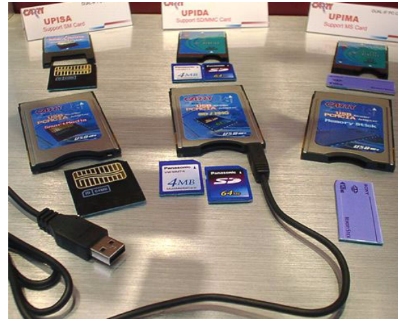
写真11 USBとメモリーカードリーダーの一体型のPCカード
