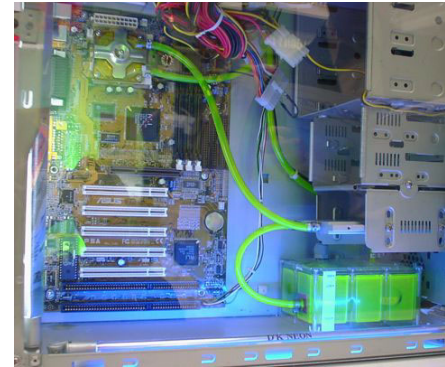
写真9 Koolance社の水冷システム
